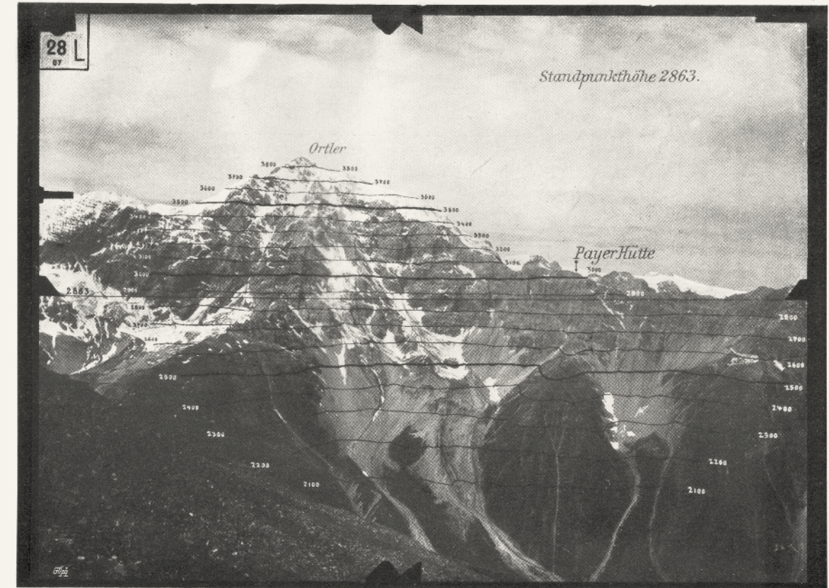
Ortleraufnahme 1907. Standpunkt 28. Linkes Bild (Suldnerhänge). Erster Versuch einer automatischen Schichtenarbeit. Die perspektivischen Schichtenlinien (Abstand 100 m) wurden durch manuelle Verbindung ermittelter Punkte gleicher Höhe erhalten.
